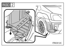
Remova os parafusos e a presilha do revestimento do paralama.
