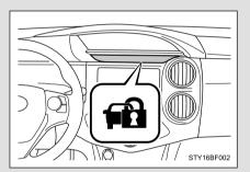
Feche as portas e o capô do motor, e trave todas as portas usando o controle remoto. O sistema será ativado automaticamente após 30 segundos.
