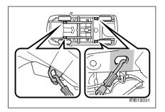
Se for transportado por um caminhão de plataforma, o seu veículo Toyota deverá ser amarrado nas posições indicadas na ilustração.
