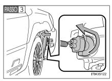
Remova parcialmente o revestimento do para-lama e gire a base da lâmpada no sentido anti-horário.
