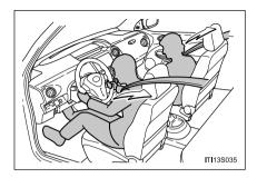
Os pré-tensionadores possibilitam uma maior proteção dos ocupantes ao retrair rapidamente os cintos de segurança quando o veículo é submetido a determinados tipos de colisão frontal grave.
