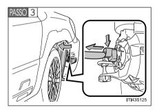
Remova parcialmente o revestimento do para-lama e solte o conector enquanto puxa a trava.
