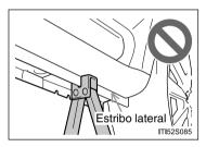
Não levante o veículo com o macaco posicionado no estribo lateral. A negligência poderá causar danos ao estribo lateral e à carroçaria do veículo.
