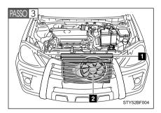
Após o motor esfriar suficientemente, inspecione as mangueiras e o núcleo do radiador (radiador) quanto a vazamentos.
