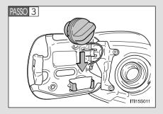
Mantenha a tampa fixada atrás da a portinhola do tanque de abastecimento.
