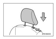
Alinhe o apoio de cabeça com os furos de instalação e empurre-o para baixo na posição de travamento.
