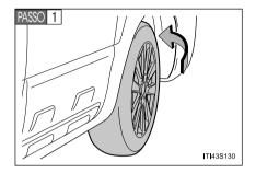
Para permitir espaço de trabalho suficiente, gire o volante de direção para o lado oposto da lâmpada a ser substituída.
