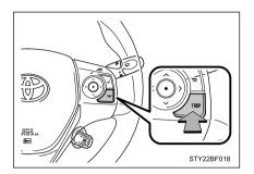
Comuta entre os itens hodômetro, hodômetro parcial e controle de luminosidade do painel de instrumentos, pressionando-se o botão "TRIP" no volante de direção.
