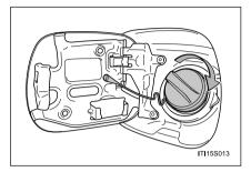
Após o reabastecimento, gire a tampa do tanque de combustível até ouvir um "click". Após soltar, a tampa irá girar levemente no sentido oposto.
