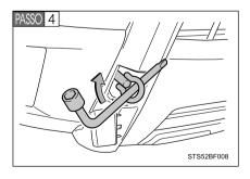
Aperte o olhal de rebocamento firmemente usando uma chave de roda ou barra de metal rígida. PASSO 5 Fixe firmemente os cabos ou correntes no olhal de rebocamento.
